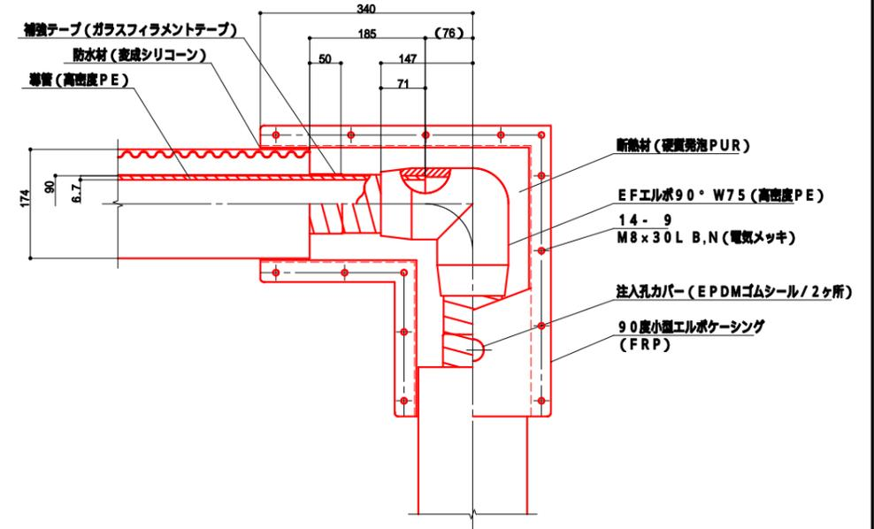
**端末継手A (PVジョイント) 詳細図 S = 1 / 5**
