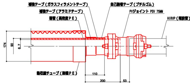
**中間継手B (EF方式) 詳細図 S = 1 / 5**
