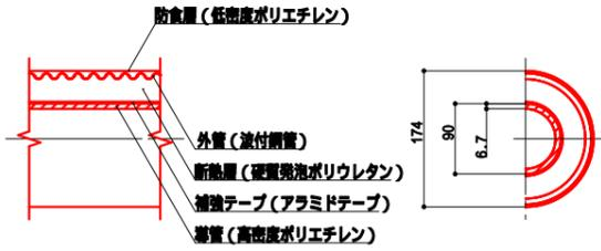
**中間継手 (スッポンジョイント) 詳細図 S = 1 / 5**
